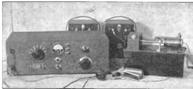
Een complete beeld-ontvanginstallatie voor amateur-gebruik volgens het Fulton-systeem, bestaande uit normale ontvanger en beeld-opnemer (geheel rechts) Lezers die de beide geïllustreerde artikelen over dit onderwerp, welke in de Nrs. 20 en 21 verschenen, niet gelezen hebben, kunnen deze nummers na inzending van f 0.50 alsnog toegezonden krijgen. Aanvragen s.v.p. te richten tot de administratie van R.-W.
